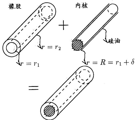
其中，导线半径为  $r_1$ ，硅油厚度为  $\delta$ ，橡胶层厚度为  $r_2 - r_1 - \delta$
